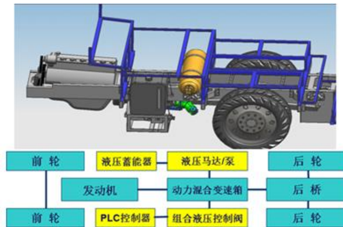
图 1 基于液力缓速节能器的城市客车原理示意图
