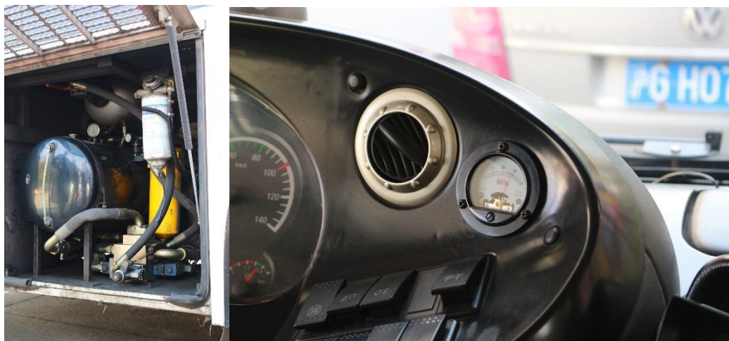
图 4 空气动力节能系统与压力指示
